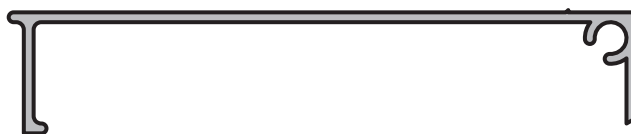
TAPACINTA Perfil: 521 Peso: 0,427 Kg/m Matriz: M1985
