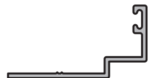
DOBLE CONTACTO Perfil: M-2471 Peso: 0,200 Kg/m Matriz: M2471
